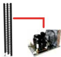
Le vetrine sono sprovviste di unità condensatrice. Tutte le vetrine vengono predisposte con valvola termostatica di serie. Le tubazioni per l'allacciamento alla linea frigorifera sono nella parte inferiore della vetrina. È necessario prevedere una linea di scarico per l'acqua di condensa e l'alimentazione elettrica.
